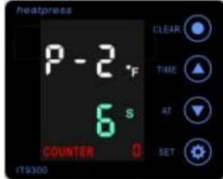
P-2: Ajuste de tiempo. Toca la tecla SET y ↑↓ para seleccionar el tiempo requerido.
