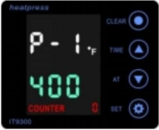
P-1: Ajuste de temperatura. Toca la tecla SET y ↑↓ para seleccionar la temperatura requerida.
