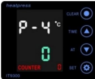
P-4: Modo apagado automático. Toca las teclas SET y ↑↓ para configurar apagado automático con un rango de 1 a 120 minutos.
