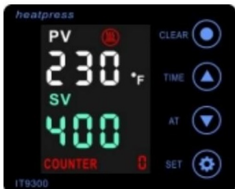
P-4: Modo apagado automático. Toca las teclas SET y ↑↓ para configurar apagado automático con un rango de 1 a 120 minutos.
